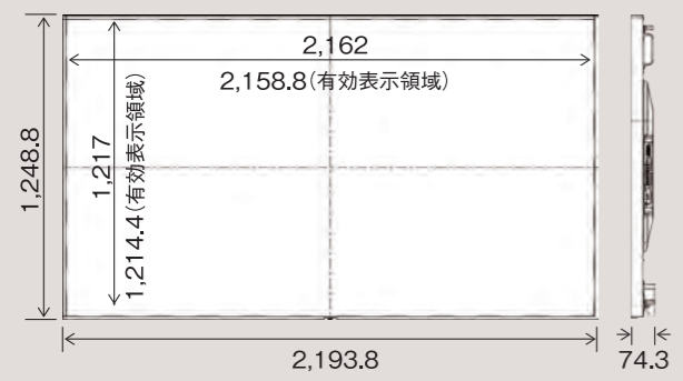
■ 86型マルチシンク液晶ディスプレイ(外形図) (単位:mm)
