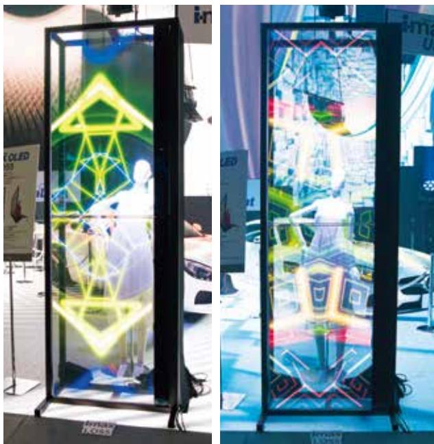
専用のディスプレイフレームにLO55を縦に2面設置した演出例
